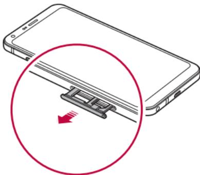
3 Do šuplíku vložte SIM kartu zlatými kontakty směrem dolů.
